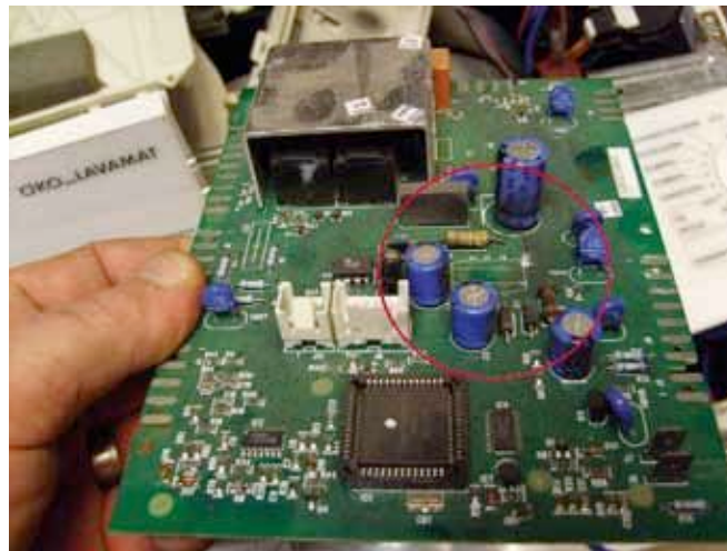
Überspannungsschaden in der Steuerplatine einer Waschmaschine
