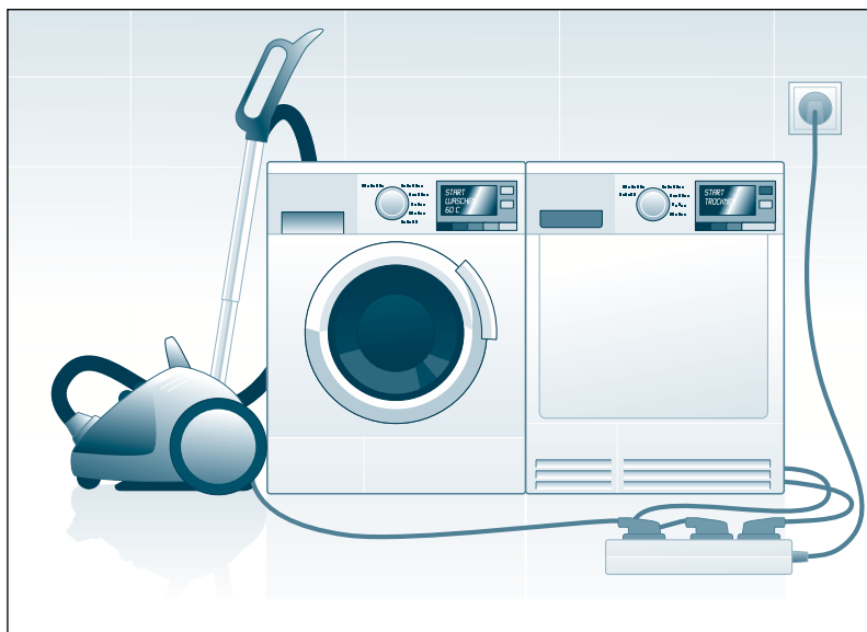
So nicht: Waschmaschine und Trockner nicht an einer gemeinsamen Steckdosenleiste bzw. an einen gemeinsamen Stromkreis anschließen.
